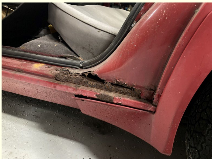
De verbinding tussen dorpel en slotplaat linksachter; rechtsachter is ongeveer in dezelfde staat.
